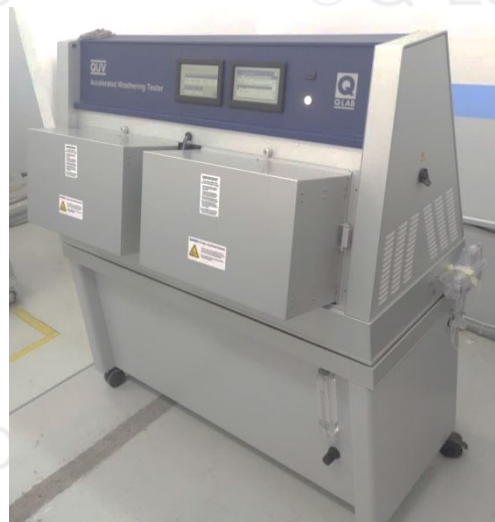
QUV với bộ gá 3D chuyên dụng (tháo cửa buồng)
